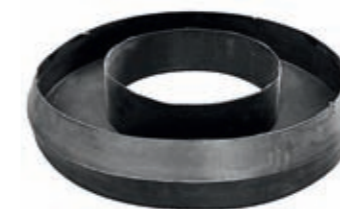
Фото 36. Форма для бетонирования до заливки бетона
